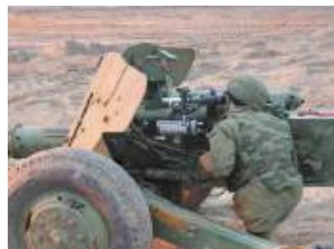
Южно-Тамбейское газовое месторождение, 2014 год. Отстрел аварийного устьевого оборудования артиллерийским снарядом
